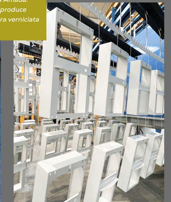
massima precisione e pulizia dei bordi. Poi la piegatura: macchine nuove, ben manutenute, con attrezzi dedicate e, dove possibile, con asservimenti robotizzati. Questa filiera ci ha portato ad avere un pezzo di ottima qualità che arriva alla fase di saldatura e immediatamente dopo alla verniciatura. Il risultato: siamo riusciti a innalzare drasticamente la qualità, la ripetibilità e l'efficienza della produzione; e, di conseguenza, la competitività dell'azienda.
